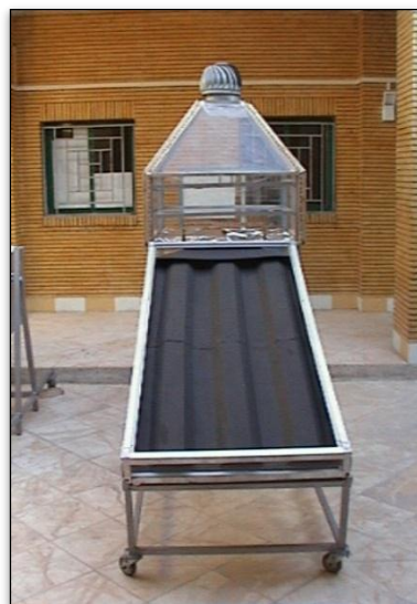
شکل ۴-۵ خشک‌کن خورشیدی مستقیم با جمع‌کننده و محفظه خشک‌کن.
