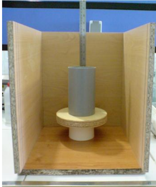
شکل ۱۲-۵ وسیله اندازه‌گیری زاویه ریپوز پرکردن در آزمایشگاه.
