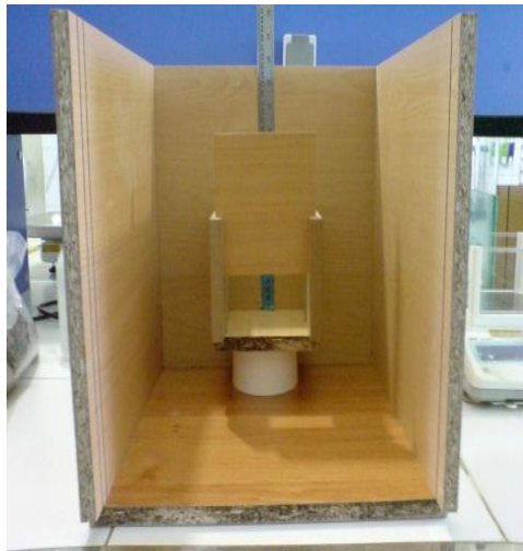
شکل ۴-۱۲ وسیله اندازه‌گیری زاویه ریبوز تخلیه در آزمایشگاه.
