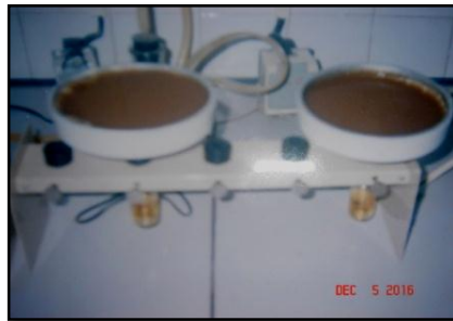
شکل ۱۲-۵ وسیله اندازه‌گیری زاویه ریپوز پرکردن در آزمایشگاه.
