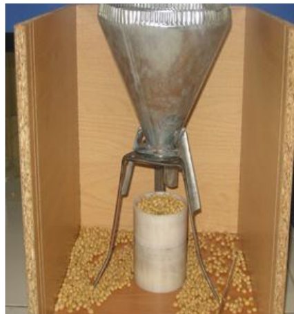
شکل ۱۲-۲ دستگاه و ادوات اندازه‌گیری دانسیته توده در آزمایشگاه.
