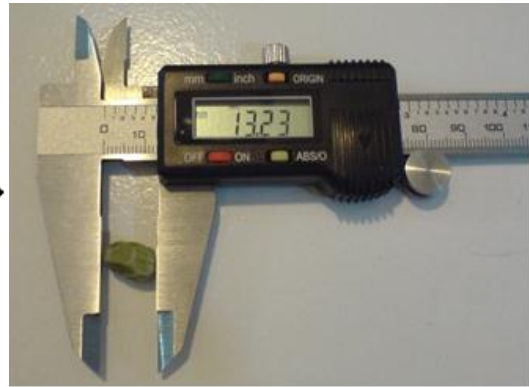
شکل ۱۲-۱ اندازه‌گیری ابعاد محوری با استفاده از کولیس دیجیتال.
