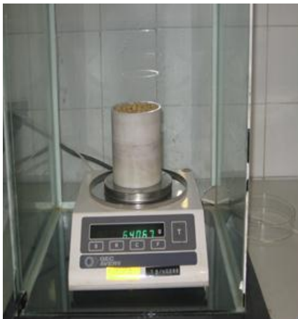
شکل ۱۲-۲ دستگاه و ادوات اندازه‌گیری دانسیته توده در آزمایشگاه.
