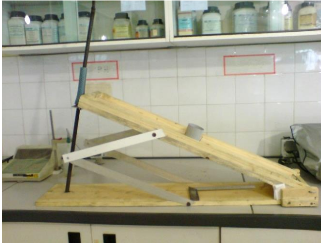
شکل ۳-۱۲ وسیله اندازه‌گیری ضریب اصطکاک ایستایی در آزمایشگاه.
