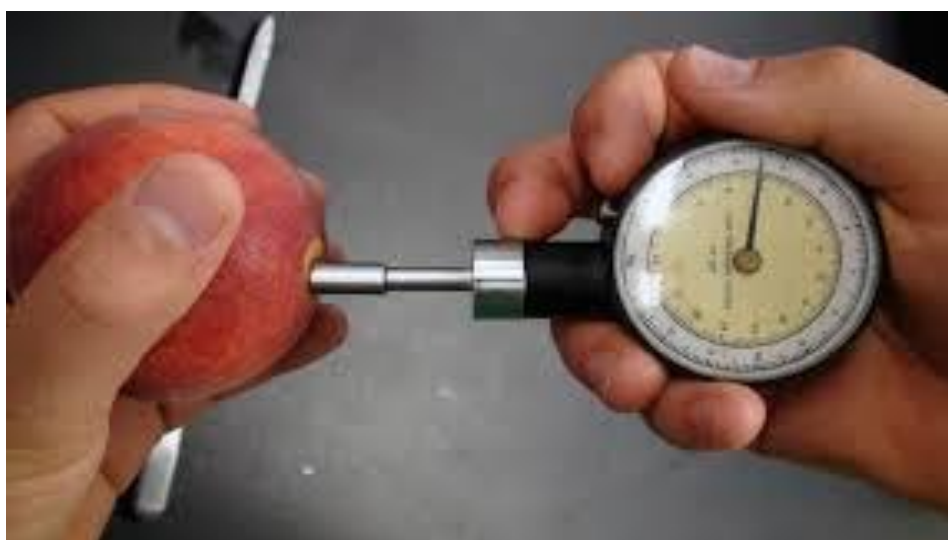
شکل ۱-۷ اندازه‌گیری میزان سفتی میوه هلو با پنترومتر دستی.
